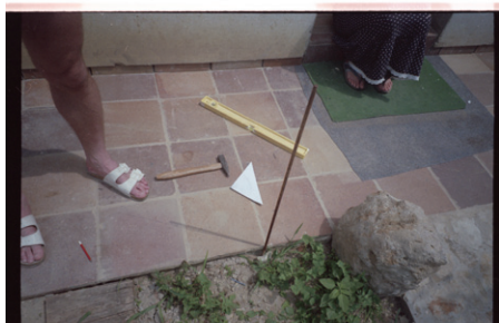
× přesné zaměření odklonu fasády od jihu v poledne, k zaměření spočteme rozdíl mezi středoevropským časem a pravým místním slunečním časem, měříme v poledne korigovaném o odchylku
